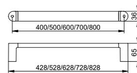
Die Ausführungen ab 928 mm sind mit einer 3. Wandbefestigung ausgeführt.
